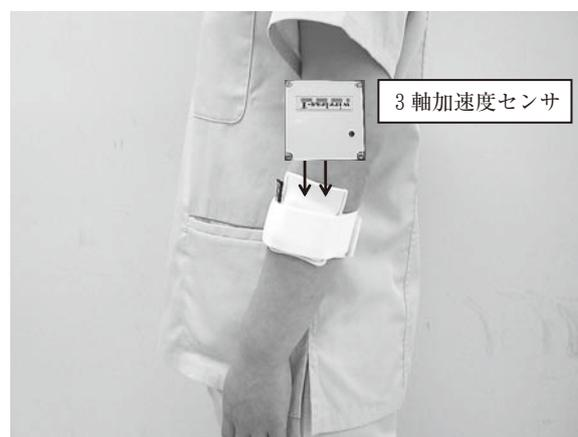
図3 3軸加速度センサの様式と専用ベルトに収納して前腕に装着した状態
