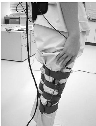
写真4. 製作した下肢関節角度検出用センサを貼付した布製装着具
