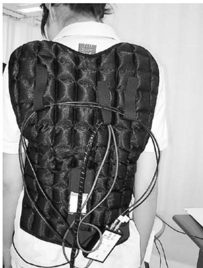
写真3. 製作した前傾角センサを貼付したベスト型装着具
